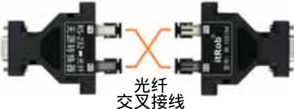
光纤交叉接线
