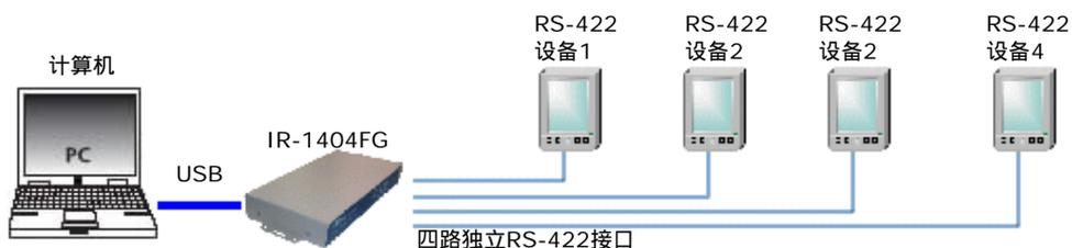
图 8.9.1 IR-1404FG同时与四台RS-422设备连接
